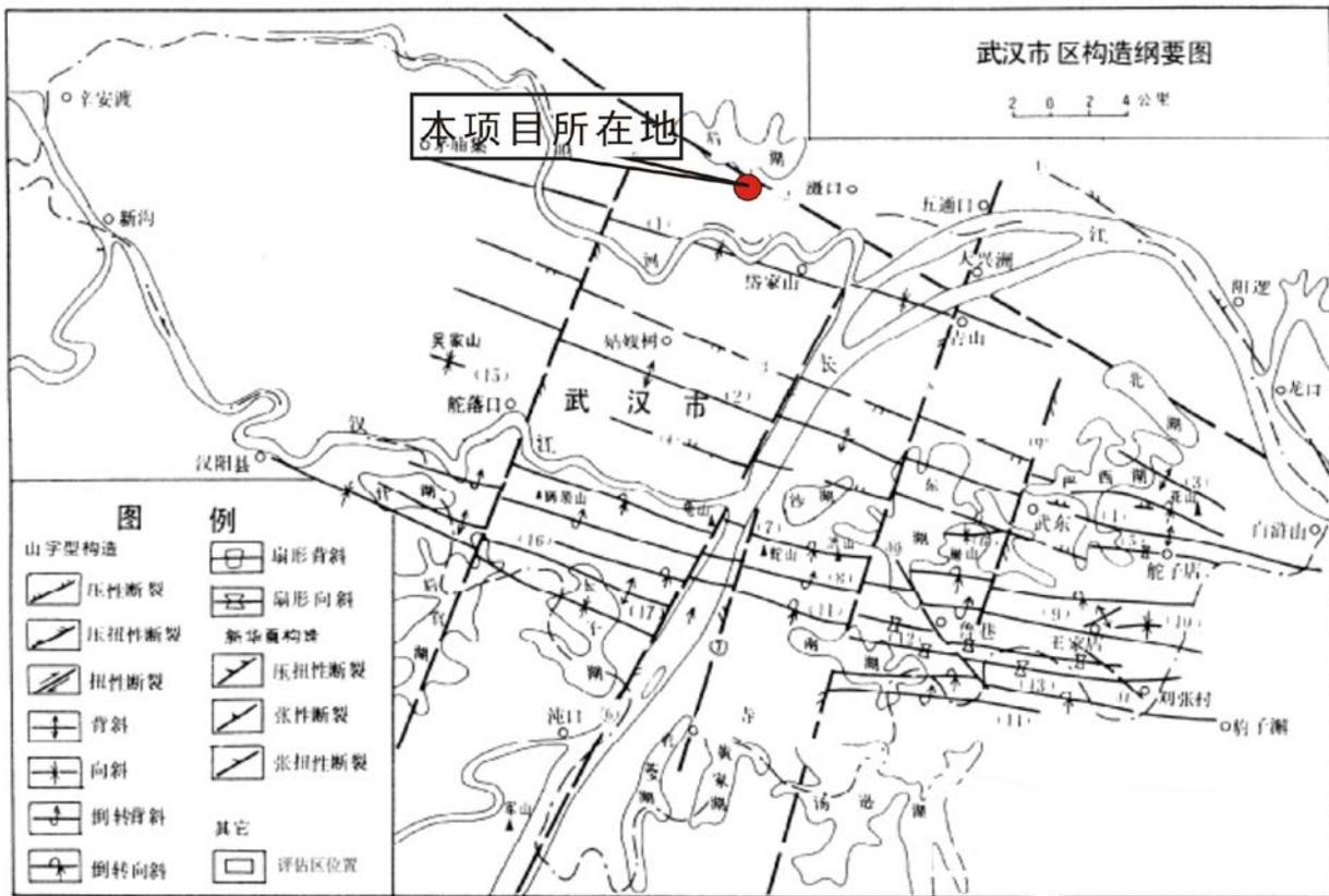
1 横店—龙口压性断裂 2 后湖—白浒山压性断裂 3 武东压性断裂 4 光庙压性断裂 5 舵落口压性断裂 6 洪家矶—金山压性断裂 7 吉菱寺压性断裂
